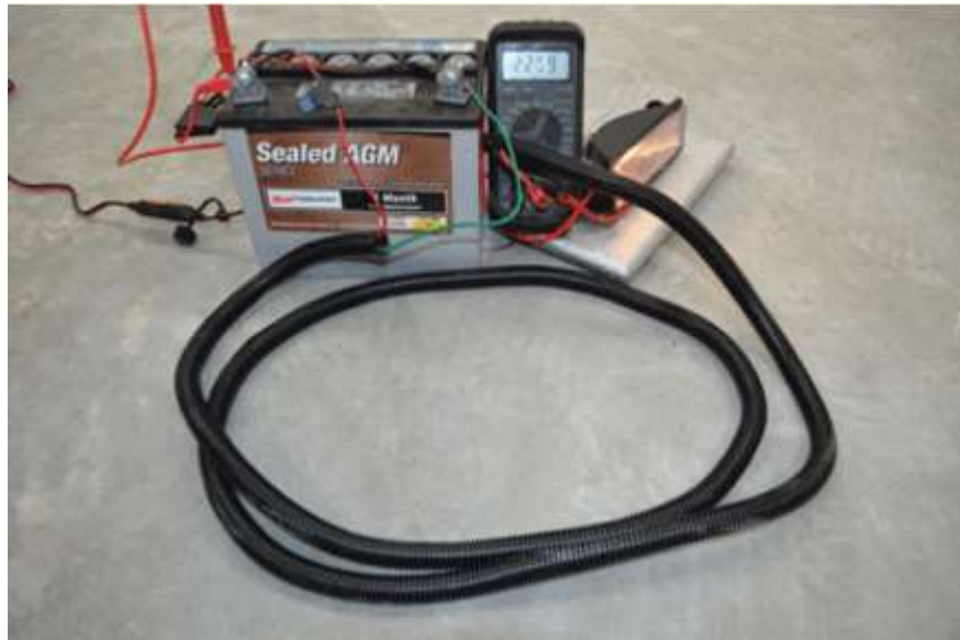
Εξομίωση κυκλώματος με μεγάλη αντίσταση λάμπας με πτώση τάσης 2.25V σε ένα καλώδιο 2 μέτρων
