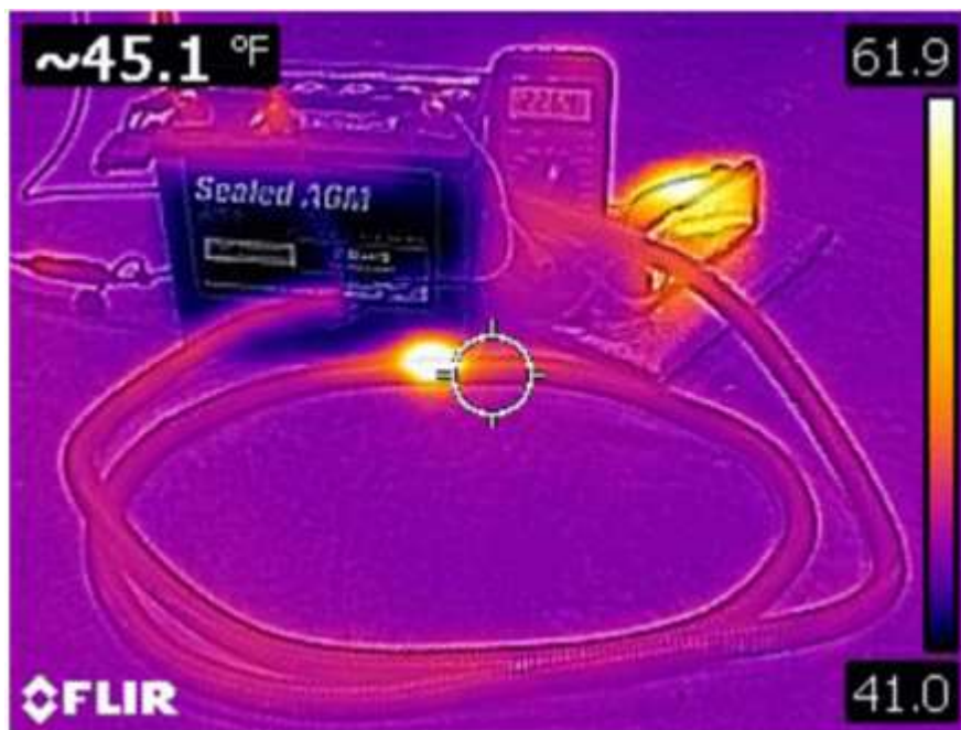
Θερμική απεικόνιση της μεγάλης αντίστασης του κυκλώματος με Θερμοκάμερα FLIR C2.
