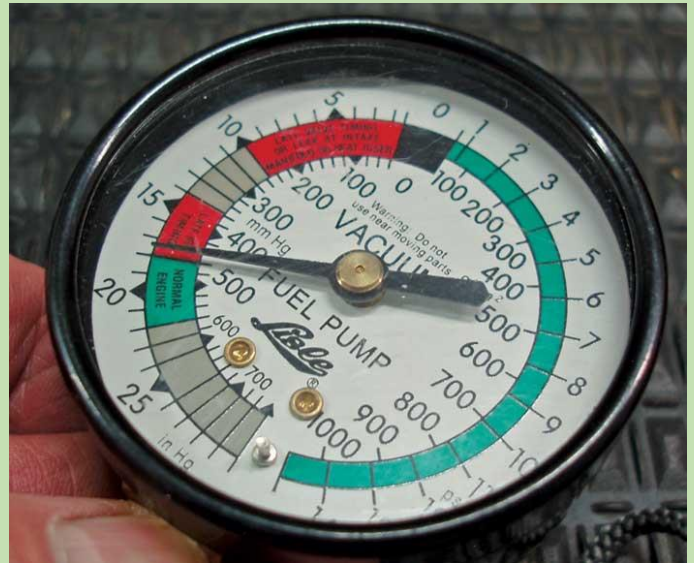
Εικόνα 2: Αυτό το «αρχαίο» μανόμετρο έχει μια κλίμακα κενού από 635 mmHg κενό μέχρι 1 Ατμ. πάνω από την ατμοσφαιρική πίεση. Όταν έχουμε να κάνουμε με υπερτροφοδοτούμενους κινητήρες με μεταβλητό χρονισμό, είναι καλύτερο να σκεπτόμαστε με όρους απόλυτης πίεσης αντί με όρους κενού.
