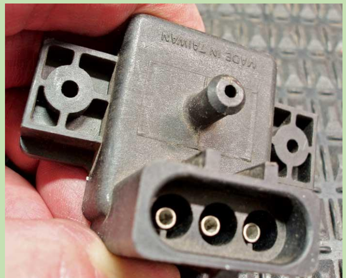
Εικόνα 3: Αυτός ο αισθητήρας MAP παλαιού δίνει ένδειξη περίπου 4.5 Volt με ανοικτό διακόπτη και περίπου 1 Volt στο ρελαντί. Στα 2.500 μέτρα η τυπική ένδειξη είναι 3.6 Volt.
