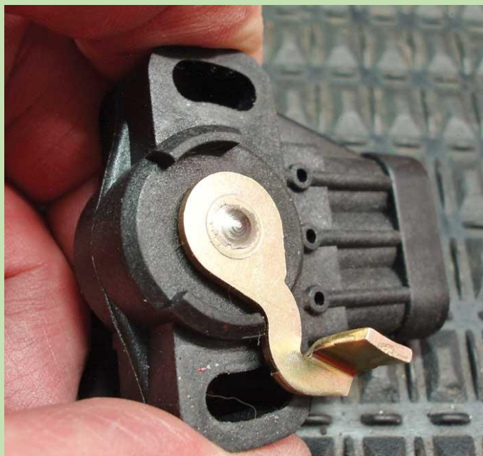
Εικόνα 4: Αυτό το ποτενσιόμετρο παλαιού τύπου με τάση αναφοράς 5 Volt δίνει τάση μικρότερη από 1 Volt στο ρελαντί και περίπου 4.5 Volt στην τελείως ανοικτή θέση. Αντίθετα, σε μια σύγχρονη μονάδα ηλεκτρογόναζου με αισθητήρες διπλής επάρκειας για τη θέση πεταλούδας, αυτοί οι αισθητήρες δίνουν αύξουσες και φθίνουσες τάσεις οι οποίες είναι σημαντικά ακριβέστερες.
